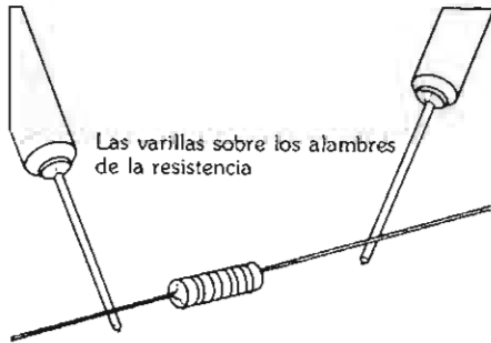
Selector de reglaje en R x 1 K
